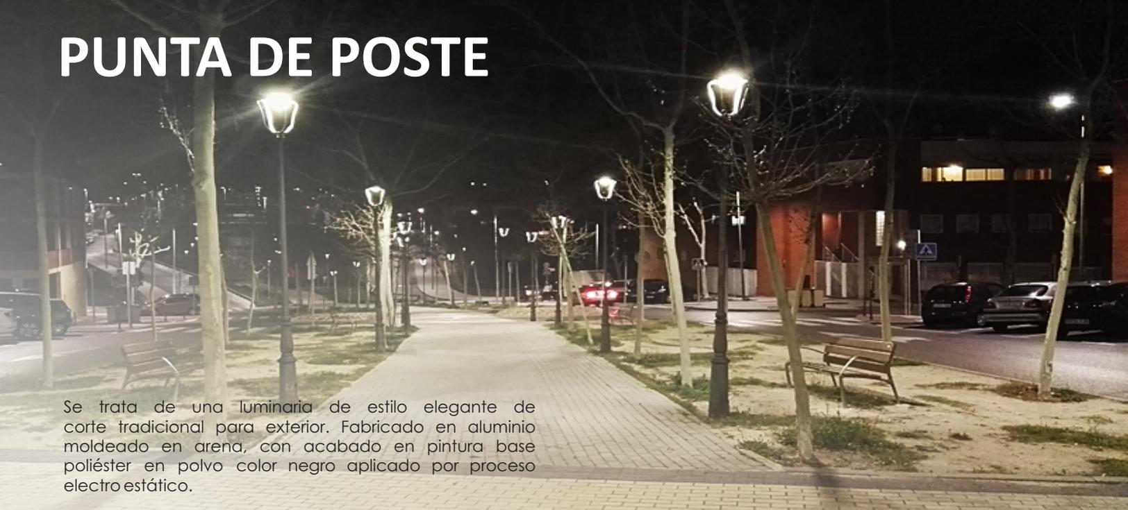
Se trata de una luminaria de estilo elegante de corte tradicional para exterior. Fabricado en aluminio moldeado en arena, con acabado en pintura base poliéster en polvo color negro aplicado por proceso electrostático.
